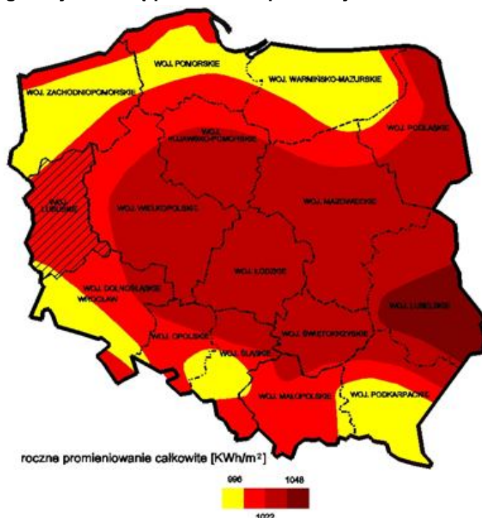
Rysunek 14 Rejonizacja średniorocznych sum promieniowania słonecznego całkowitego padającego na jednostkę powierzchni poziomej w kWh/m 2 /rok
